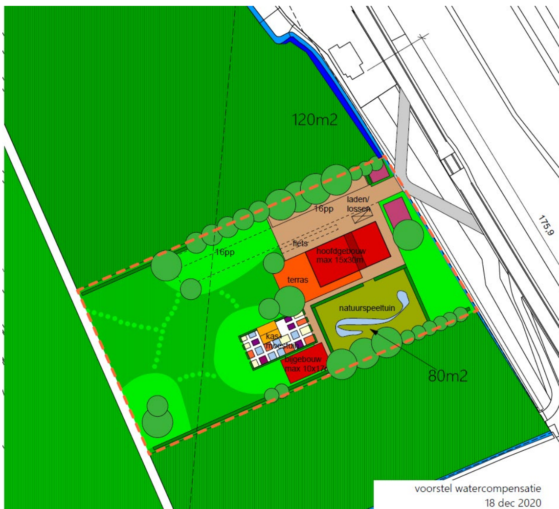
Figuur 4.11 voorstel voor 200 m 2 aan watercompensatie (80 in de natuurspeeltuin en 120 naast de watergang in het noorden van het projectgebied)
