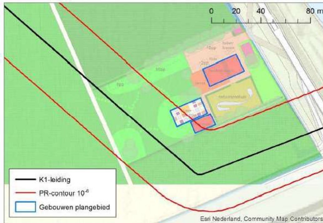
Figuur 4.6 Plaatsgebonden risicocontour 10^{-6} hogedruk K1-leiding (rode lijnen).
